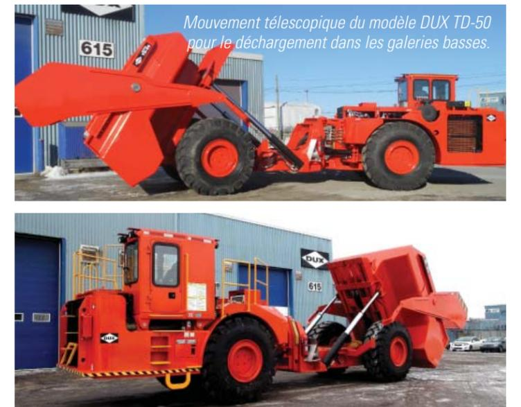
Mouvement télescopique du modèle DUX TD-50 pour le déchargement dans les galeries basses.
