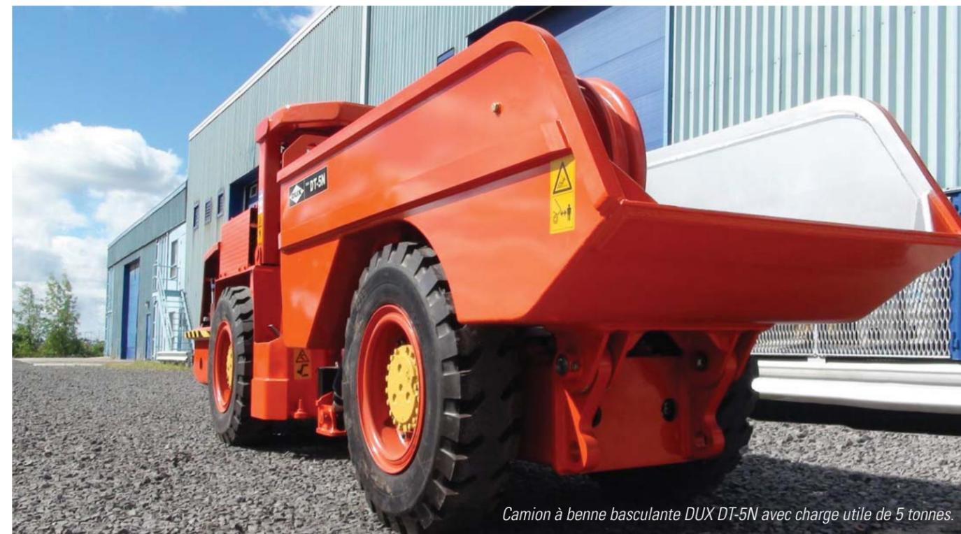
Camion à benne basculante DUX DT-5N avec charge utile de 5 tonnes.
