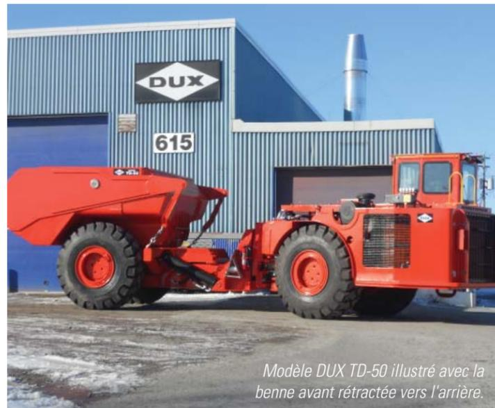
Modèle DUX TD-50 illustré avec la benne avant rétractée vers l'arrière.
