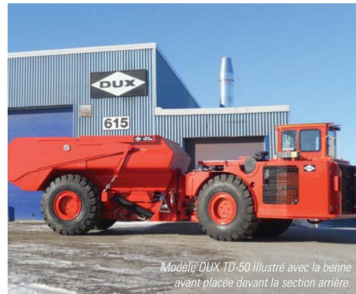
Modèle DUX TD-50 illustré avec la benne avant placée devant la section arrière.
